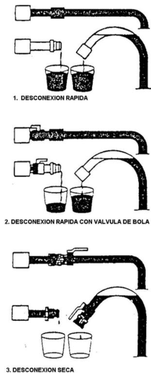
Figura 5.50 Tipos de desconexión. Adaptado de Rizzo, 1991
