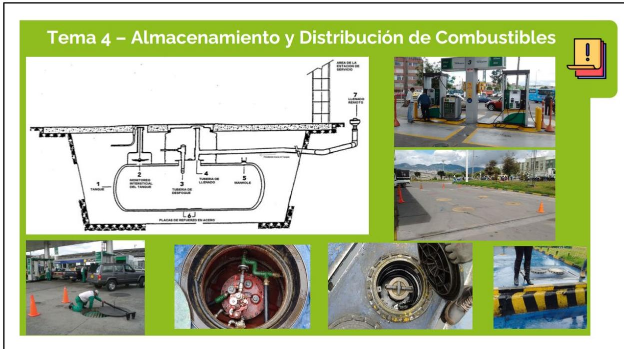
Diagrama y fotos de un tanque subterráneo de gasolina en Bogotá
